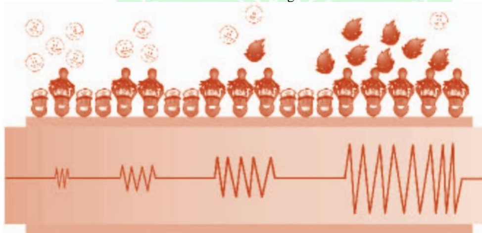
Figura 7: Biosensor piezoeléctrico. Como consecuencia de la interacción entre el elemento de reconocimiento y el analito se produce un cambio en la frecuencia de resonancia del cristal.
