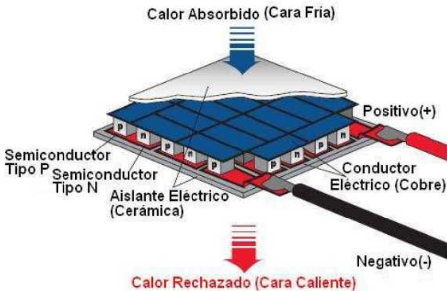
Figura 1. Diagrama que muestra la estructura interna de una celda Peltier, donde se observan los elementos semiconductores dispuestos eléctricamente en serie y térmicamente en paralelo.
