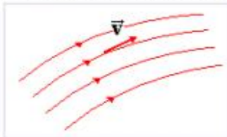
Flujo currentilíneo (Laminar)
